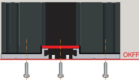
Bodenstatikprofil in EV1 mit der Positionierungsnut und dem Abdichtungsband Serienmäßig. Unten mit einem optimalen Querschnitt garantiert eine absolut formstabile Konstruktion unserer Türen, die sehr wichtig für den Transport und eine schnelle und genaue Montage ist.
